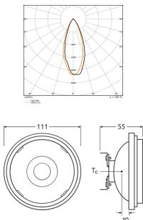
**Scheda tecnica Ledvance Faretti LED G53 AR111 11.7W 800lm 40D - 930 Luce Calda | Miglior resa cromatica - Dimmerabile - Sostitua 75W**
